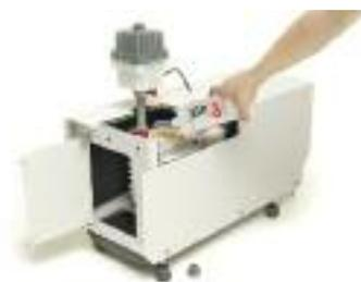
Adición de aceite para bomba previa (bomba rotatoria), 4 l
