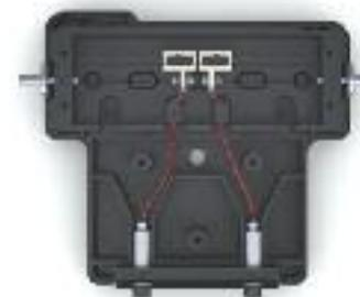
Celda de flujo Max-Light HDR, vista del interior, para mostrar paso óptico corto de 3,7 mm para concentraciones altas, G4212-60032
