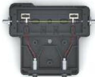
Celda con cartucho Max-Light, vista interior, paso óptico de 60 mm para altas concentraciones, G4212-60007
